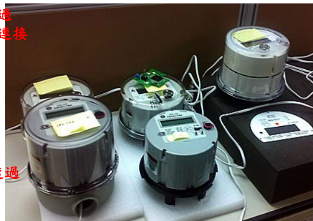
各通訊技術測試 (ZigBee, PLC, WiFi電表進行測試)
