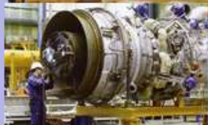
Промышленная ГТУ фирмы SIEMENS, SGT-700
